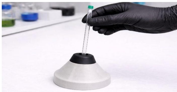
Figura 9. Tubo de RMN en el dispositivo durante la prueba de agitación.
